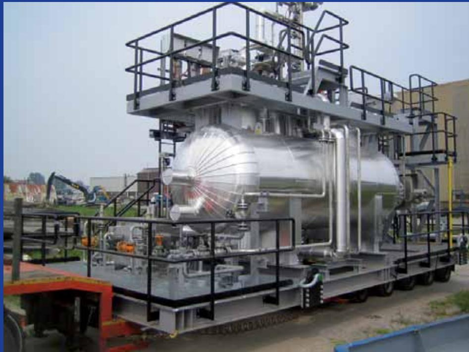
PMF speelt in op de wereldwijde trend van modulair bouwen. Modulair bouwen levert een positieve bijdrage aan efficiency en veiligheid zowel voor offshore als onshore toepassingen. Wij kunnen omvangrijke skids in onze werkplaats produceren. Als het gaat om assemblage en testen heeft PMF de juiste specialisten in huis. Assemblage geschiedt door gecertificeerde flensmonteurs.
